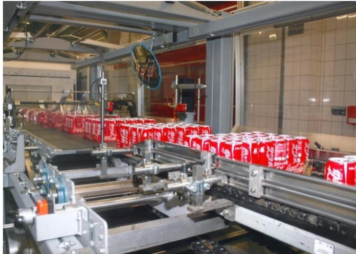
Imagem 9 – Processo de empacotamento de grupo de latas Fonte: Professional Articles: “Yes we can”
