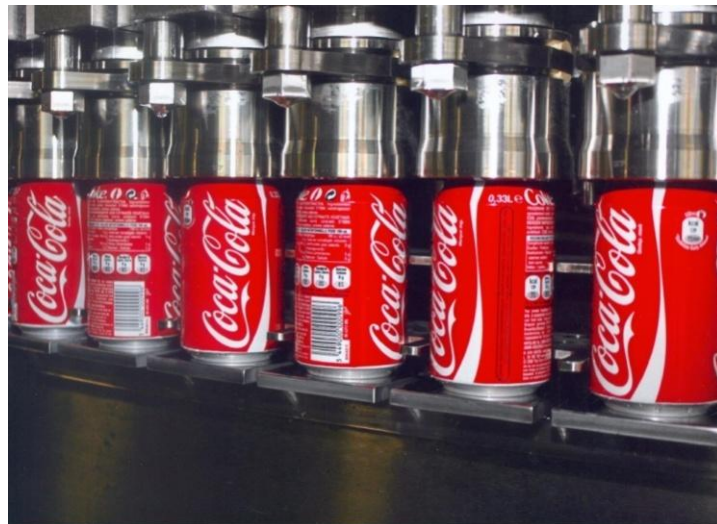
Imagem 6 – Processo de recravação Fonte: Professional Articles: “Yes we can”
