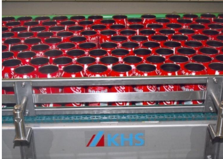
Imagem 2 – Transportador de latas Fonte: Professional Articles: “Yes we can”
