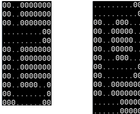
Figura 4.1 – Dois glifos, com dimensões diferentes, gerados pelo método Font:: genFreetypeAlphabet() .
