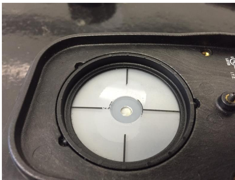
Figura II - Posicionamento do aparelho espectrofotômetro sobre cartão cinza
