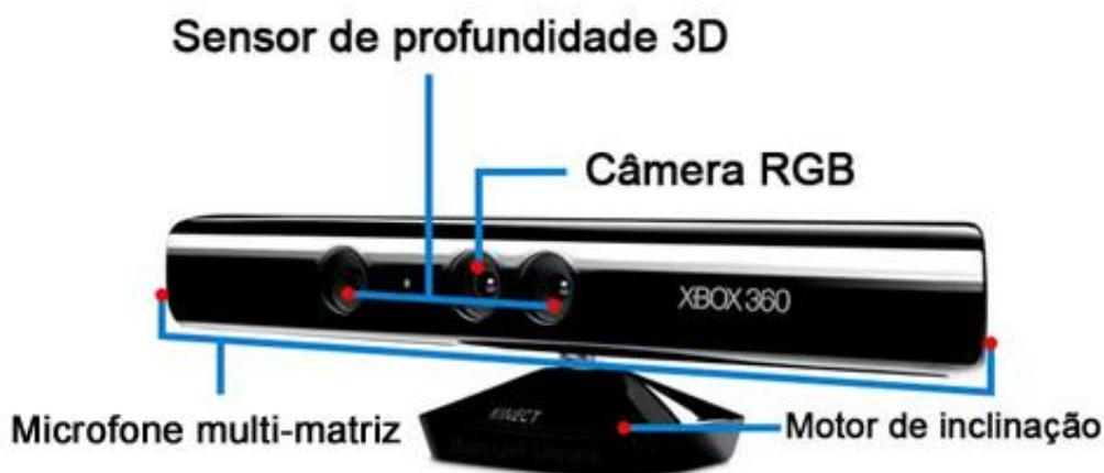
Figura 2 - Partes do *hardware* do Kinect
