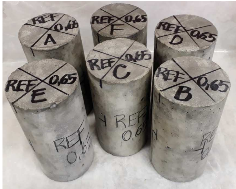
Figura 29 - Marcação feita nos corpos de prova para as medições de resistividade elétrica.
