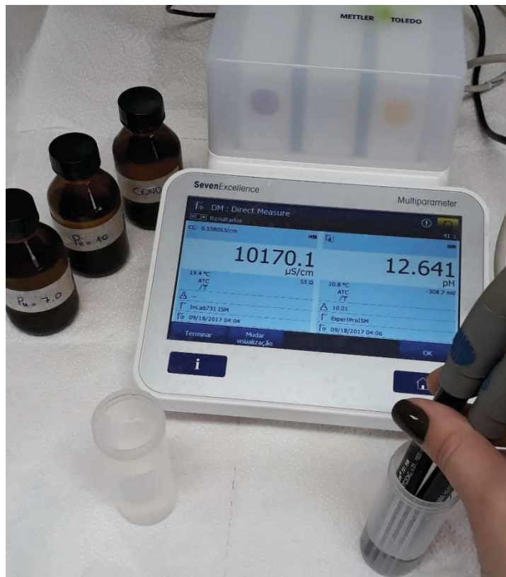
Figura 32 - Ensaio de condutividade elétrica e pH.
