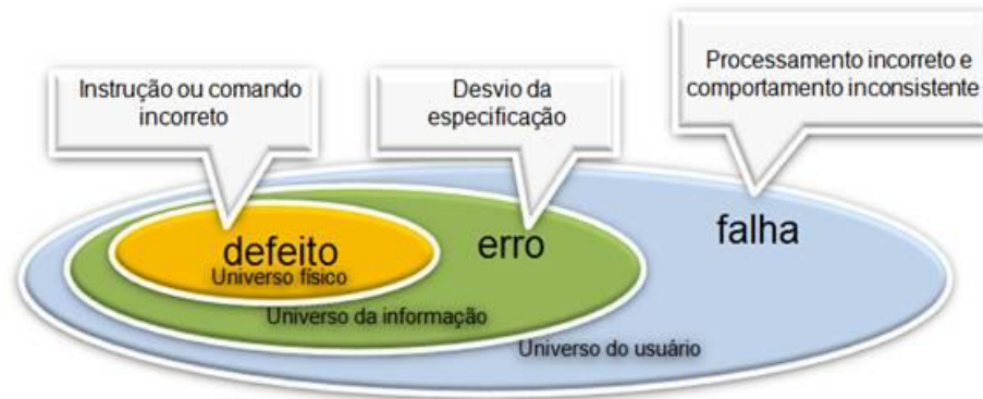
Figura 1 Defeito x Erro x Falha
