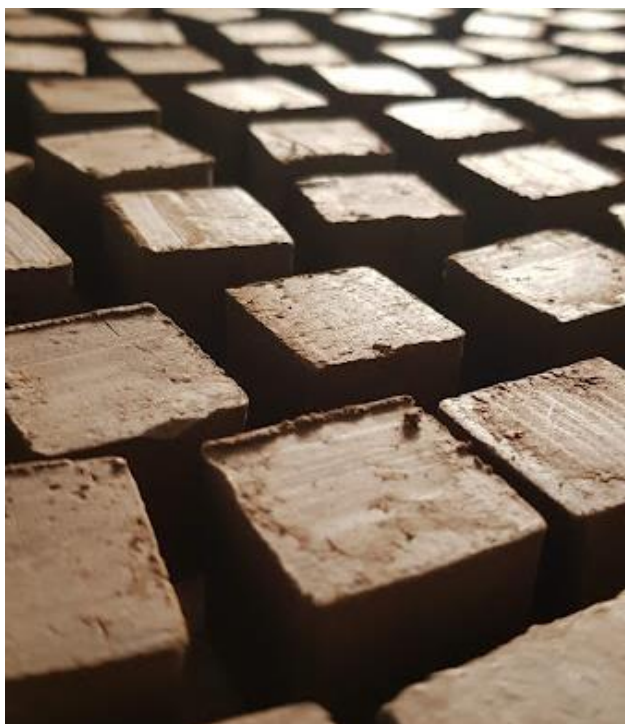
Figura 8 – Blocos cerâmicos em processo de secagem.
