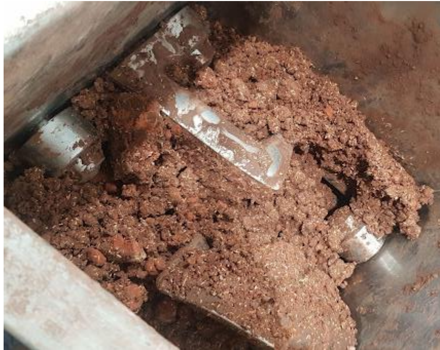
Figura 4 – Malaxador homogeneizando a mistura de argilas, LTE e CA.
