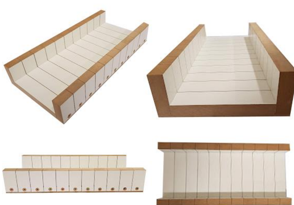
Figura 7 – Gabarito utilizado para cortar o tarugo em cubos.
