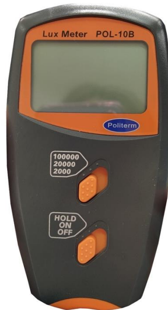
Figura 12 – Luxímetro utilizado para controlar a iluminação dos blocos.
