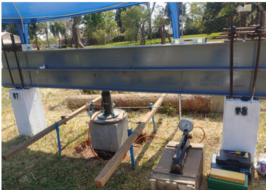
Figura 15 – Sistema do ensaio de prova de carga estática (PCE) na estaca EC01.
