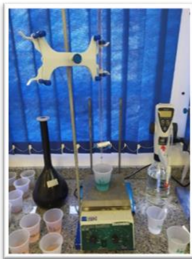
3ª etapa: Titulação com solução de HCl 0,1 M.
