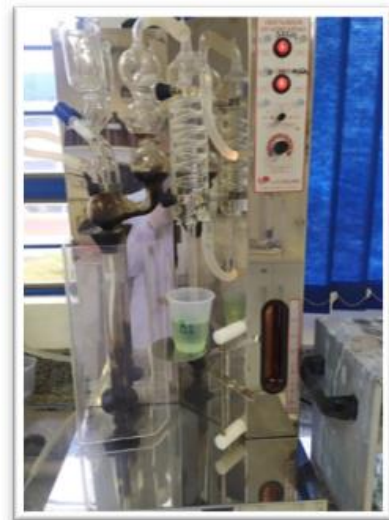
2ª etapa: Destilação com indicador de ácido bórico.
