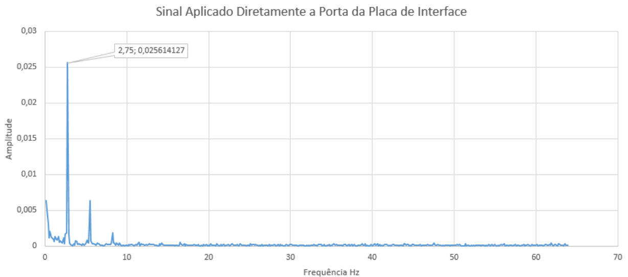
Figura 45 - Representação Gráfica do Sinal Correspondente a Frequência de 2,75Hz.
