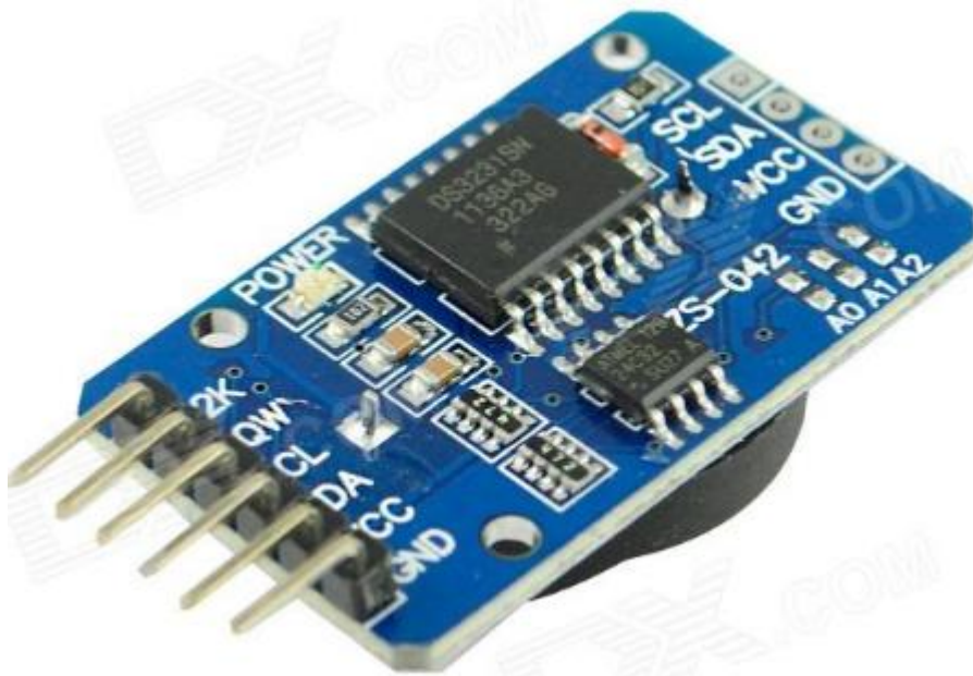
Figura 37 - Modelo do Relógio DS3231 [MAXIN INTEGRATED, 2015].
