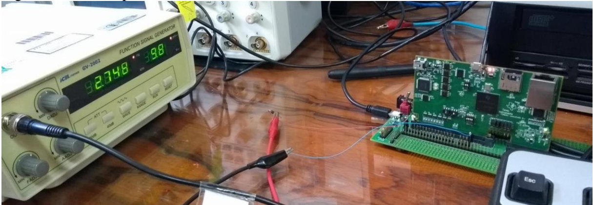
Figura 40 - Sinal Aplicado Diretamente ao Microcontrolador.
