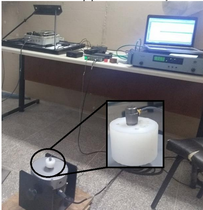
Figura 51 - Bancada de Testes com os Equipamentos da Briuel & Kjaer .
