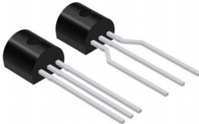
Figura 27 - Regulador de tensão LP2950-3 [TEXAS INSTRUMENTS,2016].
