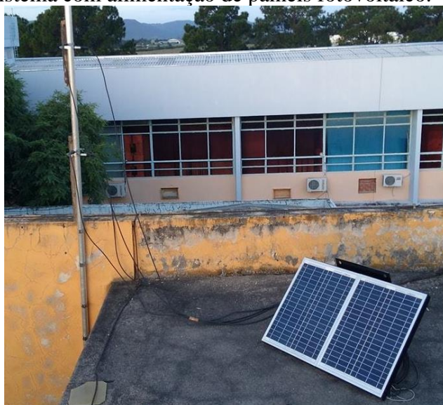
Figura 67 - Teste do sistema com alimentação de painéis fotovoltaico.
