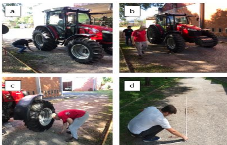
Figura 6: Procedimento para verificação do avanço cinemático: a) Marcação do início da primeira volta do pneu; b) Contagem do número de voltas dos rodados; c) Marcação da última volta do rodado; d) Medição da distância percorrida
