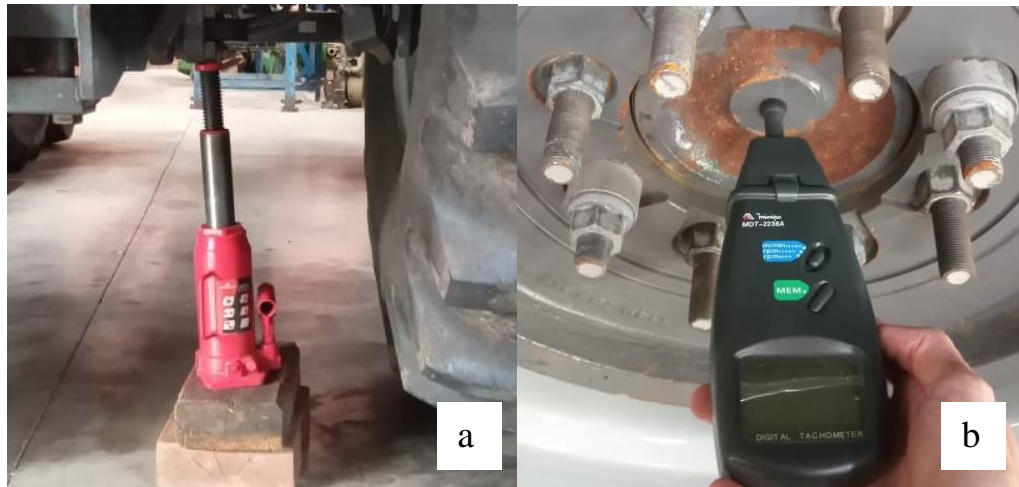
Figura 4: Suspendendo a roda (a) e tacômetro no centro do eixo (b)
