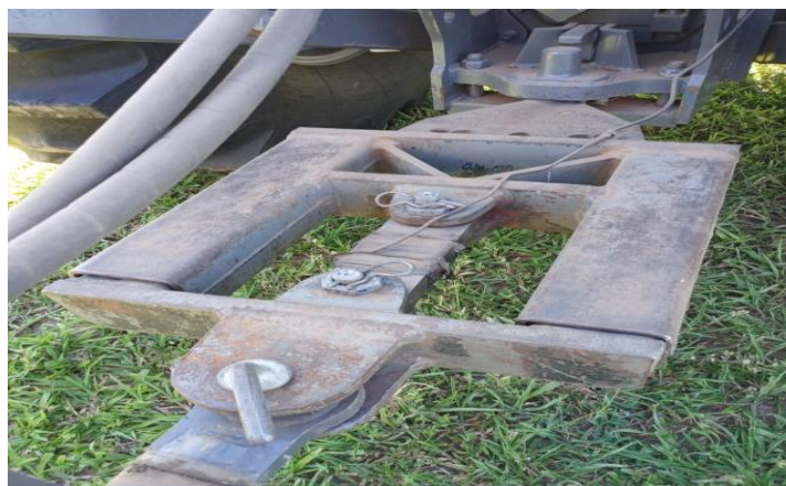
Figura 9: Sistema de engate e célula de carga
