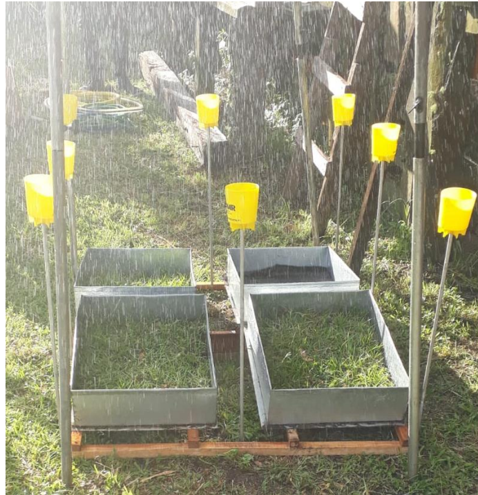
Figura 9 - Disposição e alocação dos copos coletores sob o simulador.
