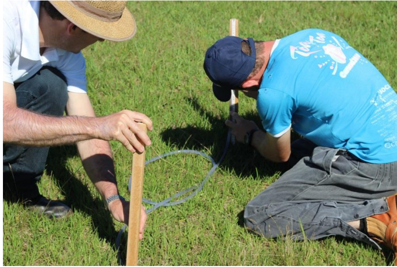
Figura 5 - Utilização do nível de mangueira para determinação da declividade.
