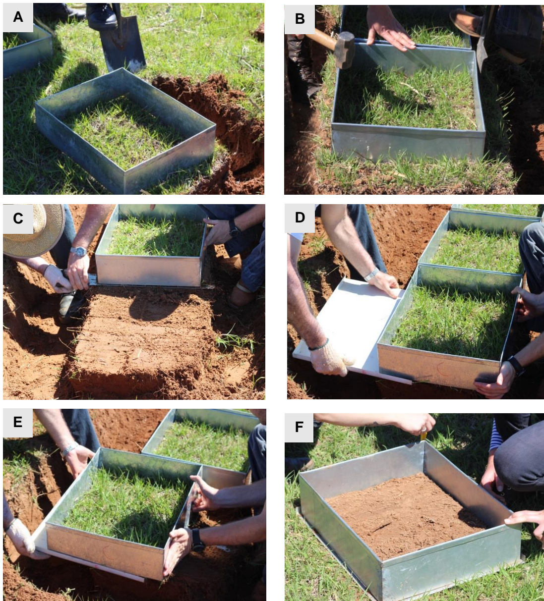
Figura 7 - Sequência de extração das leivas contendo vegetação (A até E) e da leiva testemunha (F).
