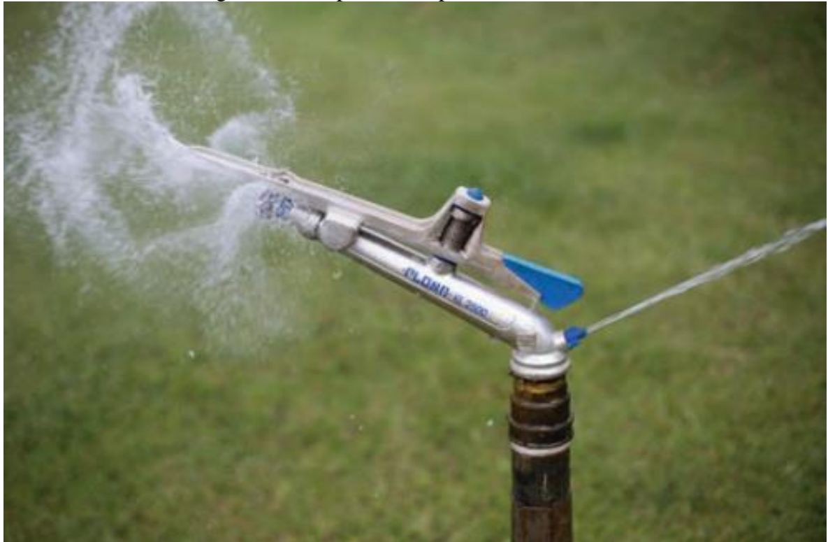
Figura 2.8 – Aspersor do tipo canhão hidráulico.
