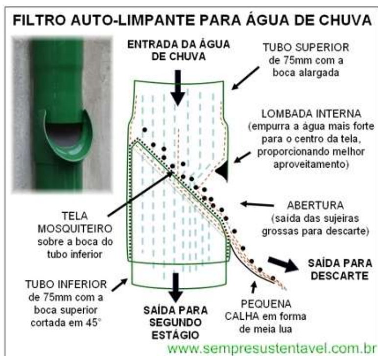
Figura 7 - Filtro Autolimpante para água de chuva
