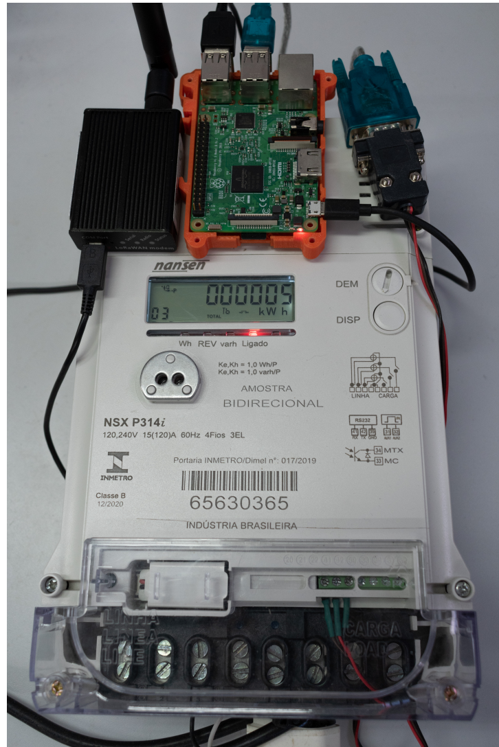
Figura 31 – Setup do dispositivo 1 juntamente com o medidor inteligente de energia elétrica.
