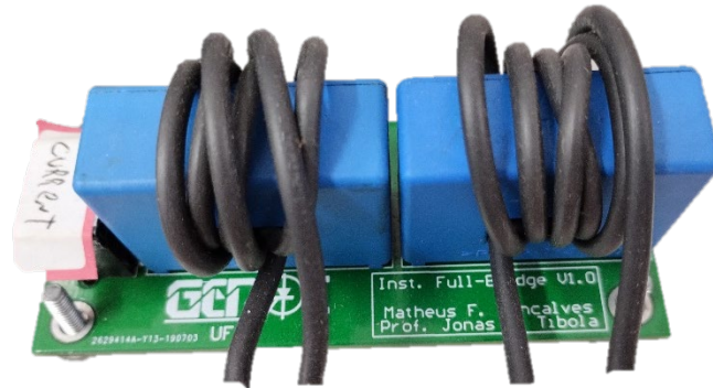
Figura 72 - Sensor de corrente em ensaio de calibração
