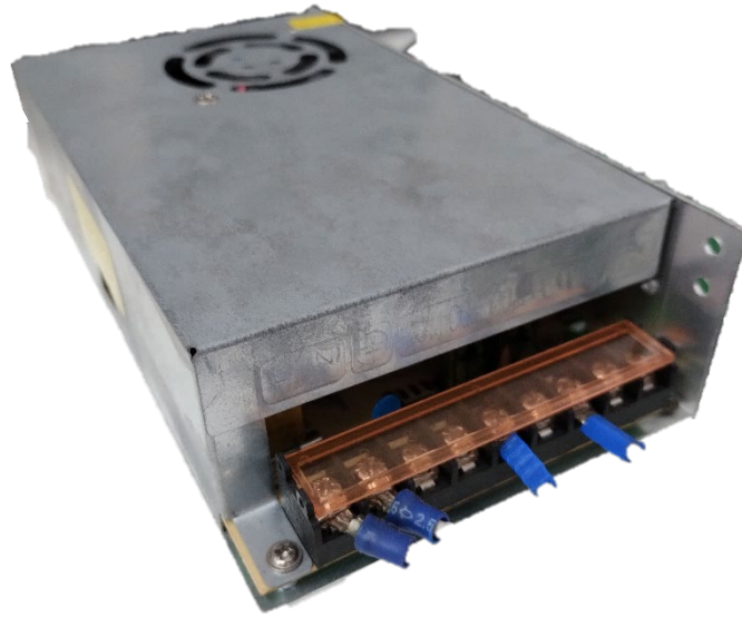
Figura 50 - Fonte de tensão utilizada (480 W)
