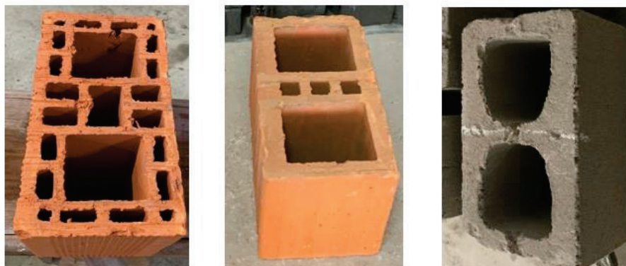
Figura 33 – Blocos utilizados na pesquisa a) bloco cerâmico de parede vazada, b) bloco cerâmico de parede maciça, c) bloco de concreto.
