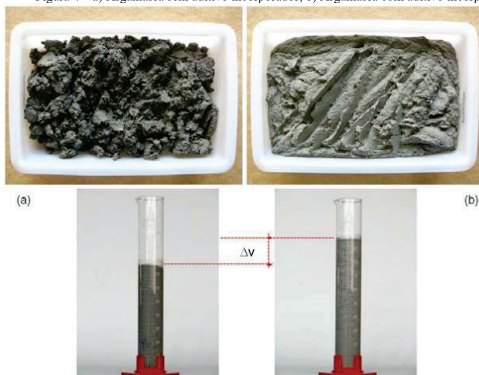
Figura 4 – a) Argamassa sem aditivo incorporador; b) Argamassa com aditivo incorporador.
