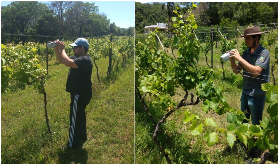
Figura 8 - Uso do espectrorradiômetro portátil FieldSpec Hand Held 2 VNIR ASD para coleta de dados espectrais em videira na vinícola Velho Amâncio
