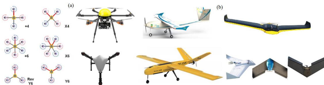
Figura 3 - Modelos de aeronaves remotamente pilotadas do tipo multirrotores (a) e do tipo asa fixa convencional e em delta (b).
