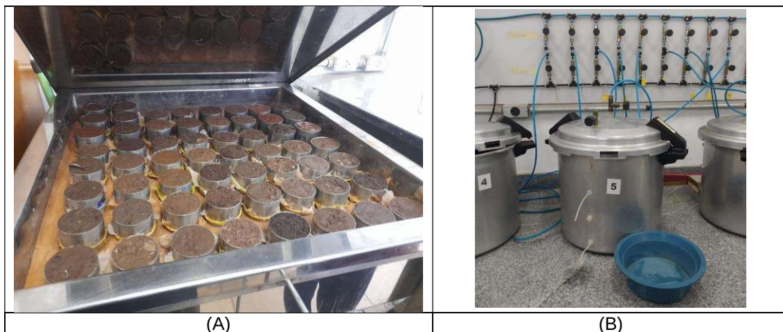
Figura 48 - Amostras na coluna de tensão (A) e câmara de Richards(B).
