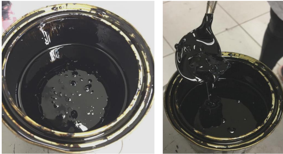
Figura 17 – Ligante asfáltico com SBS adicionado. (a) Após 1 hora de alto cisalhamento. (b) Após 5 horas de baixo cisalhamento.
