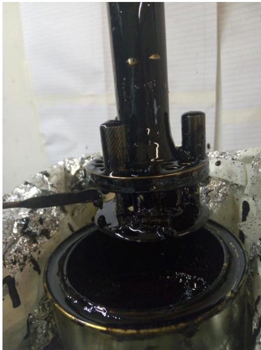
Figura 7 – Utilização de espátula de metal para retirada de pellets presos ao cabeçote.
