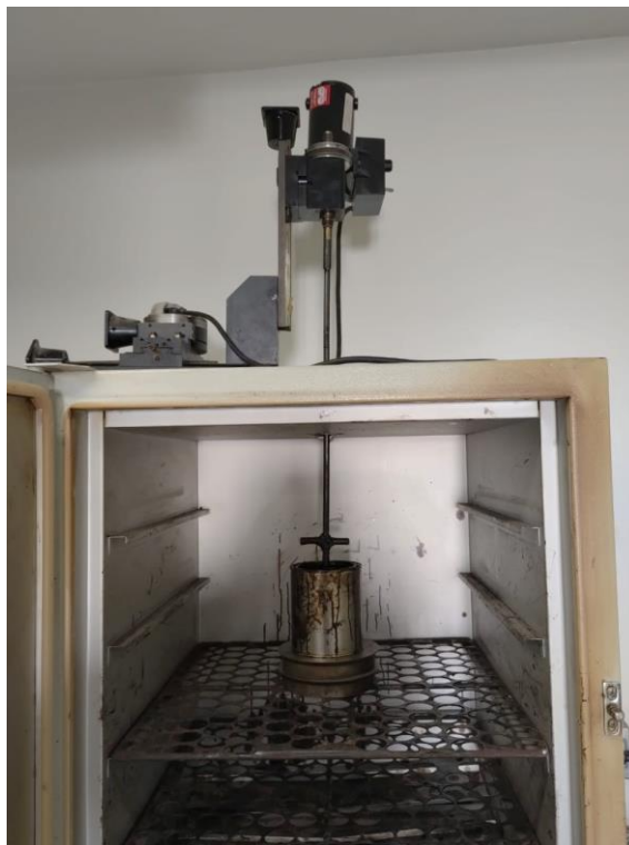
Figura 6 – Parafusadeira adaptada para baixo cisalhamento.
