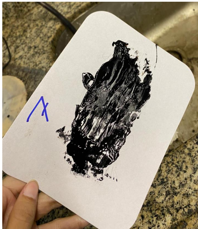
Figura 8 – Smear test realizado durante alto cisalhamento.
