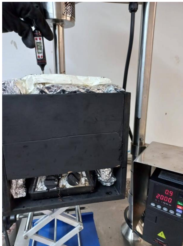
Figura 5 – Conjunto adaptado para mistura à 180 °C.
