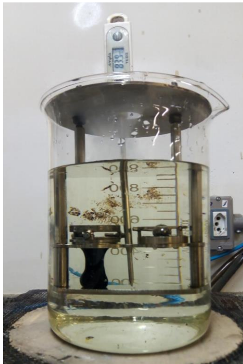
Figura 46 – Indicação de separação de fase pelo ensaio de ponto de amolecimento.
