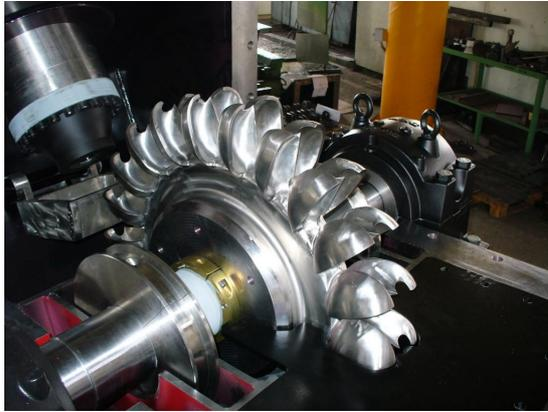
(a) Rotor de Turbina Pelton. Fonte: (GRETEK, 2018).
