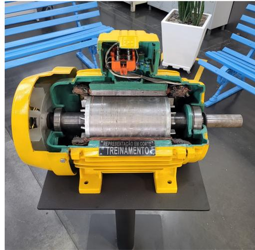
(b) Representação em corte de Motor Elétrico. Fonte: Autor.
