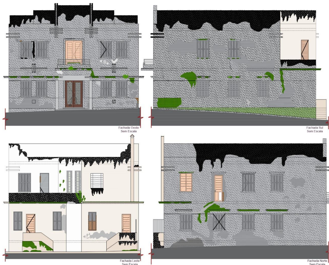
Figura 3 - Fachadas da Residência com patologias. Fonte: Arquivo elaborado pela autora com base em levantamento realizado por Jéssica Bortoluzzi e Thaís Ferreira, 28 de abril de 2019.
