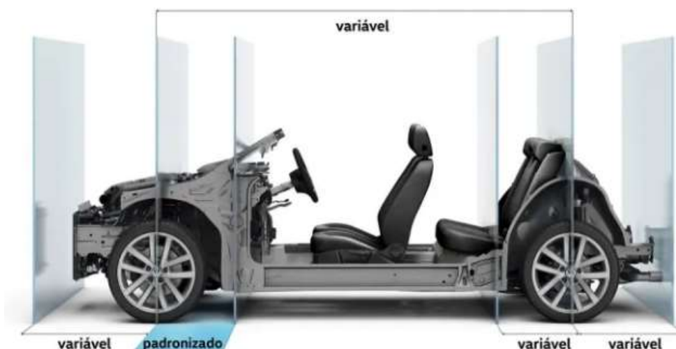
Figura 6: Kit de montagem modular com motor transversal (MQB).
