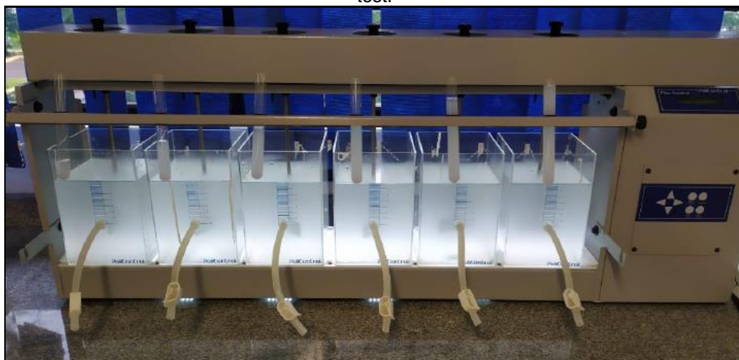
Figura 7 - Simulação de tratamento da água com coagulante a base de quitosana no aparelho Jar test.
