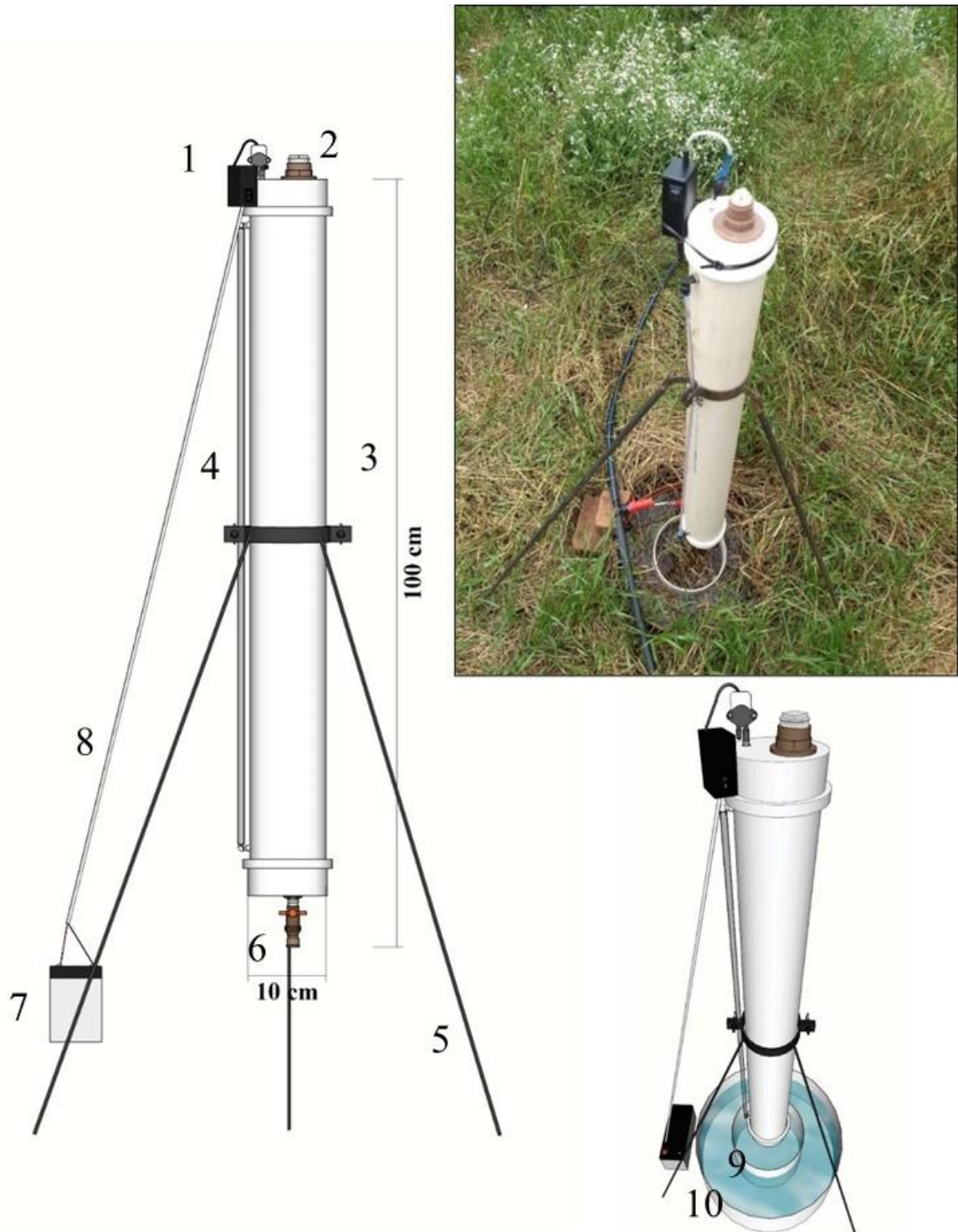
Figura 3 - Aspectos gerais do infiltrômetro de duplo anel concêntricos construído, e do acoplamento do sistema para obtenção automática dos dados de infiltração. 1) caixa com microcontrolador e sensor de pressão diferencial (MPX5010DP); 2) abertura para abastecimento de água, com tampa do tipo rolha para vedação; 3) coluna de PVC que abastece a água do anel interno; 4) mangueira transparente para verificação manual do nível de água; 5) tripé de sustentação; 6) adaptador do tipo flange com registro de esferas para saída da água; 7) bateria 12 V; 8) cabo duas vias para alimentação de energia; 9) anel interno; 10) anel externo.
