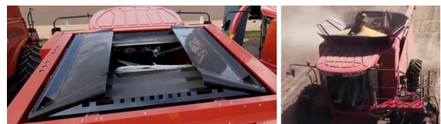
Figura 3. Colhedora da marca Case-IH, no lado esquerdo com as extensões do tanque graneleiro fechadas e no lado direito abertas.
