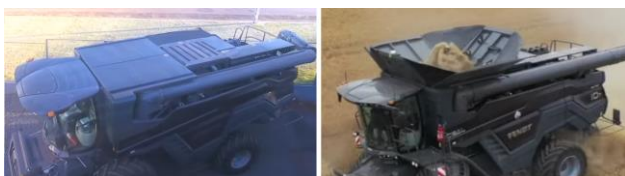
Figura 1. Colhedora da marca Fendt, no lado esquerdo com as extensões do tanque graneleiro fechadas e no lado direito abertas.
