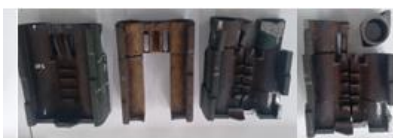
Figura 2: Telha cortada para remoção de corpos de prova e análise de rechupes. Fonte: Autor
