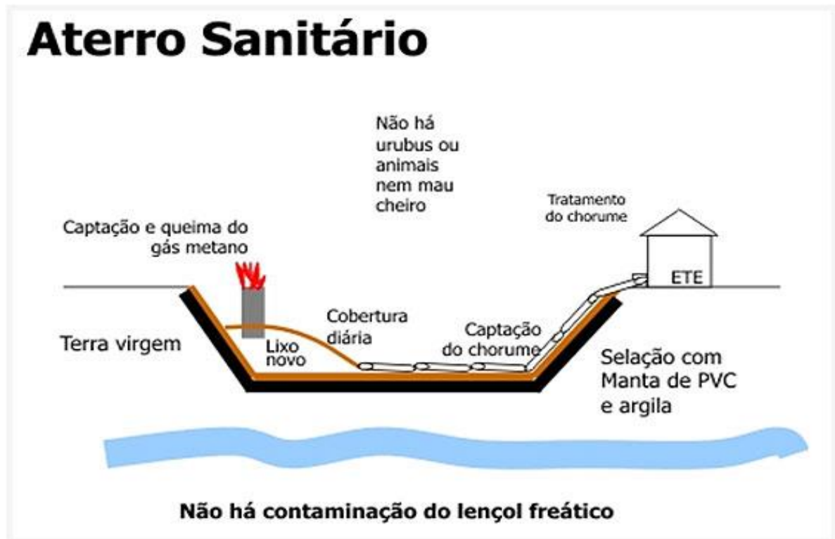
Figura 1 – Aterro sanitário. FONTE: ART; RAFAEL. 2013.
