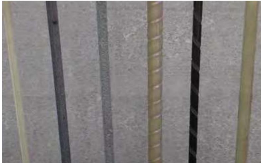
Figura 3 - Modelos de tratamento superficial em barras de FRP
