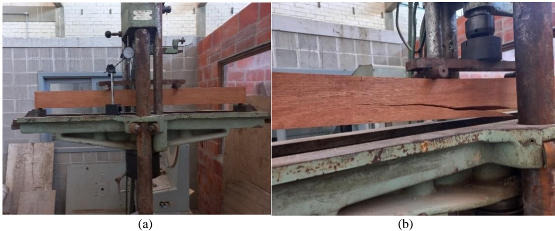
Figura 26 – Sequência de ensaio de resistência à flexão de quatro pontos em vigas referência de Cedrinho. (a) início da aplicação de cargas; (b) instante de ruptura da viga.
