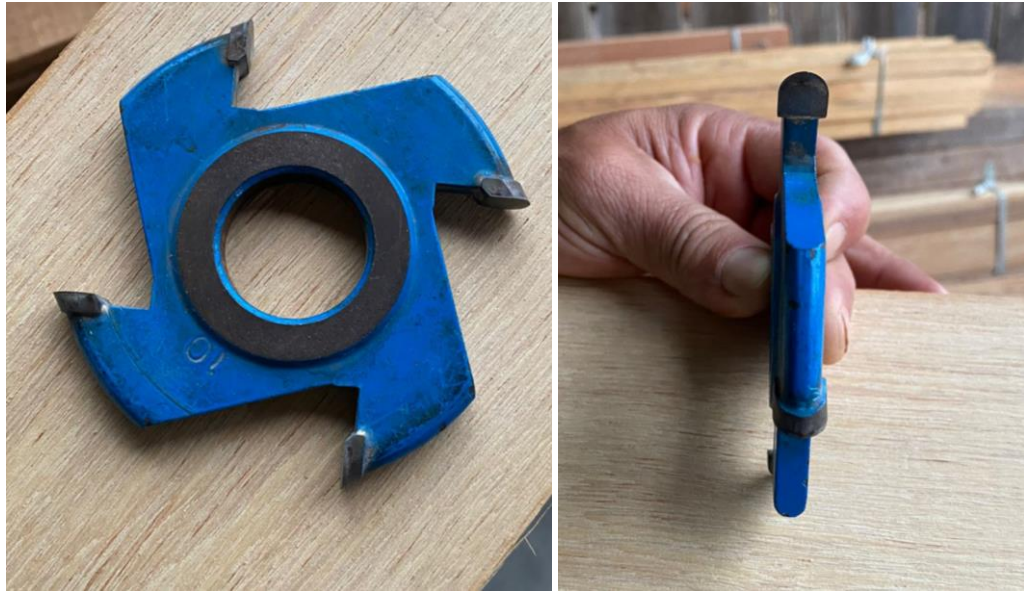
Figura 16 – Fresa circular de 8.0 mm utilizada para a execução do entalhe nas vigas de madeira
