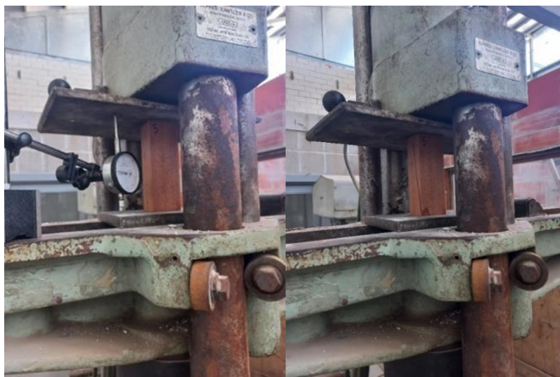
Figura 20 – Ensaio de resistência à compressão paralela as fibras
