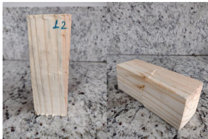
Figura 24 – Corpo de prova da madeira Pinus após o ensaio de resistência à compressão paralela as fibras
