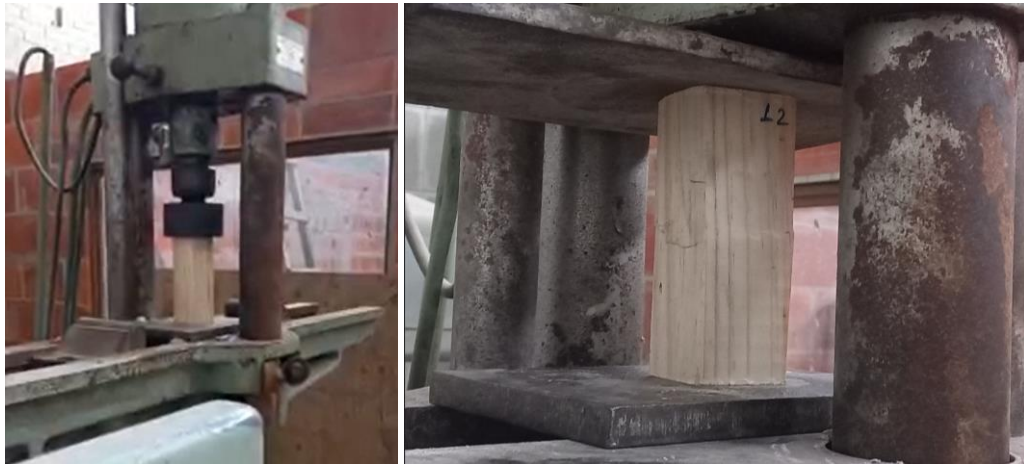
Figura 23 – Ensaio de resistência à compressão paralela as fibras na madeira Pinus
