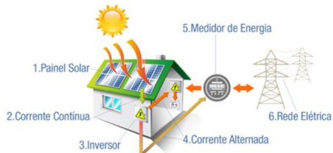
Figura 6 – Esquema do sistema fotovoltaico conectado a rede.
