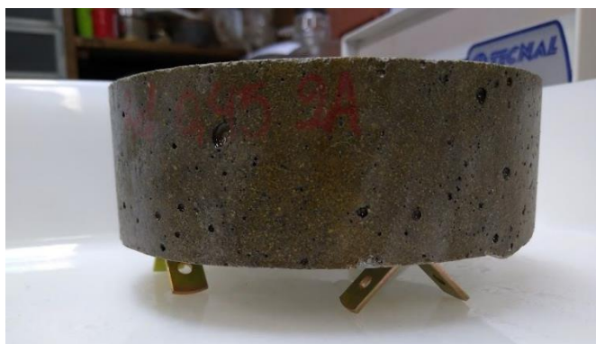
Figura 3.21 – Amostra preparada para o ensaio de absorção de água.
