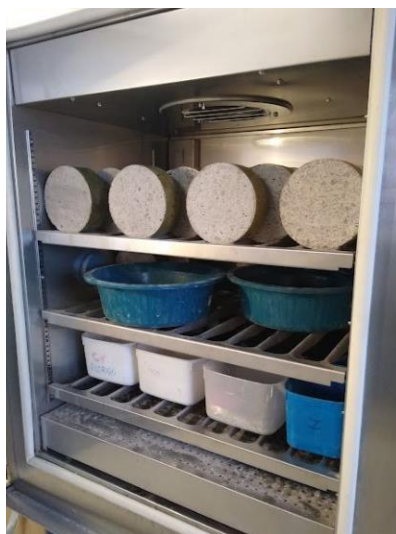
Figura 3.19 – Amostras em espaço com temperatura e umidade controladas
