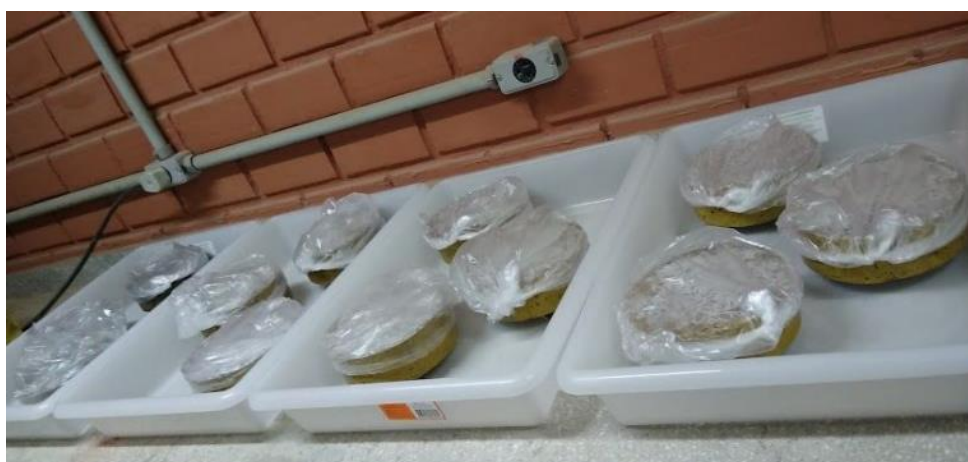
Figura 3.22 – Ensaio de absorção de água em execução.
