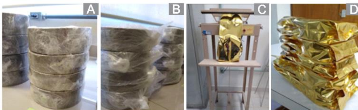
Figura 3.20 – Selagem amostras para a etapa de redistribuição da umidade.
