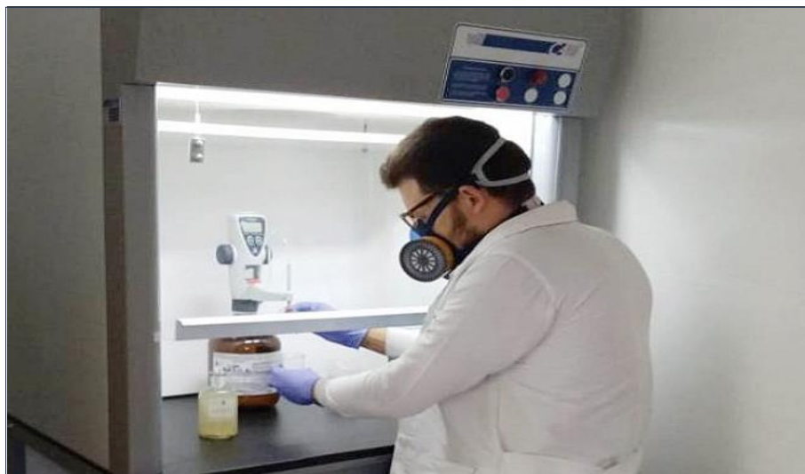
Figura 16 – Capela de química com exaustão
