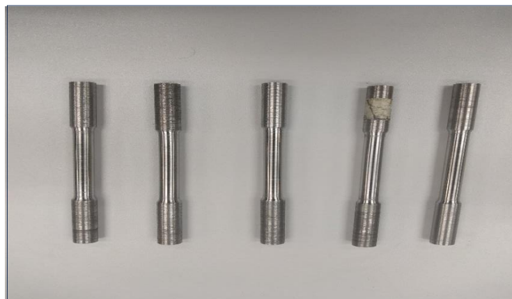
Figura 10 – Corpo de prova barra circular
