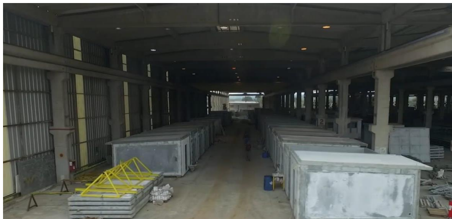
Figura 45 – Produção dos módulos em concreto
