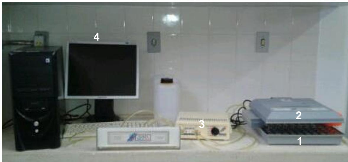
**Figura 1** – Componentes de um condutivímetro individual: 1) bandeja de plástico compartimentada; 2) placa multisensora; 3) dosificador; 4) computador e monitor. UFSM 2013.
