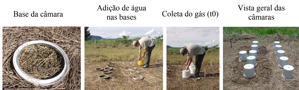
Figura 3.1 – Vista geral do dispositivo utilizado para medir a emissão de N 2 O.
