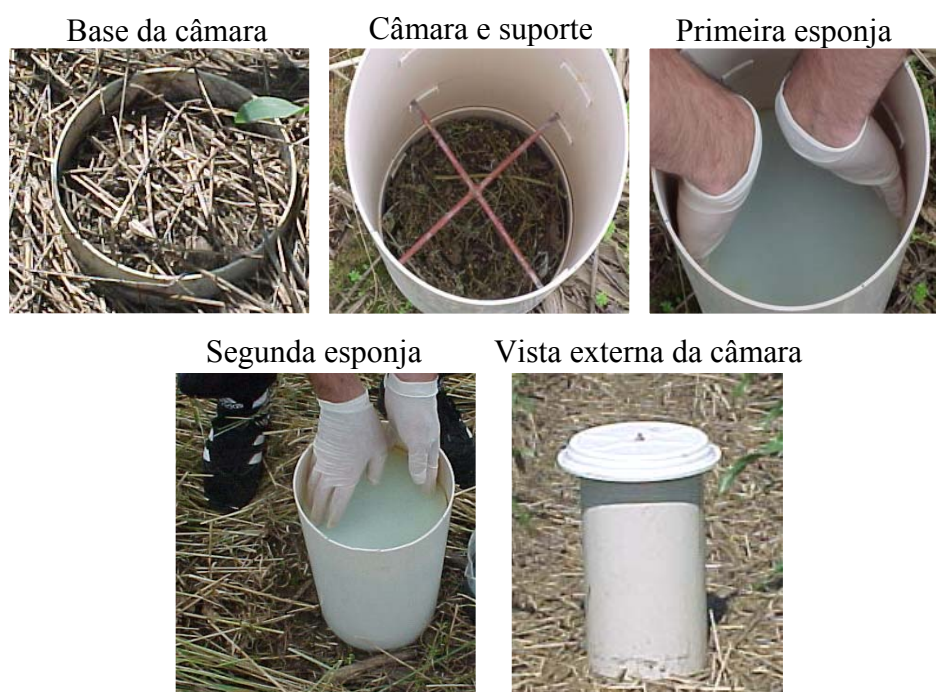
Figura 1.3 – Dispositivo utilizado para medir a volatilização de amônia.
