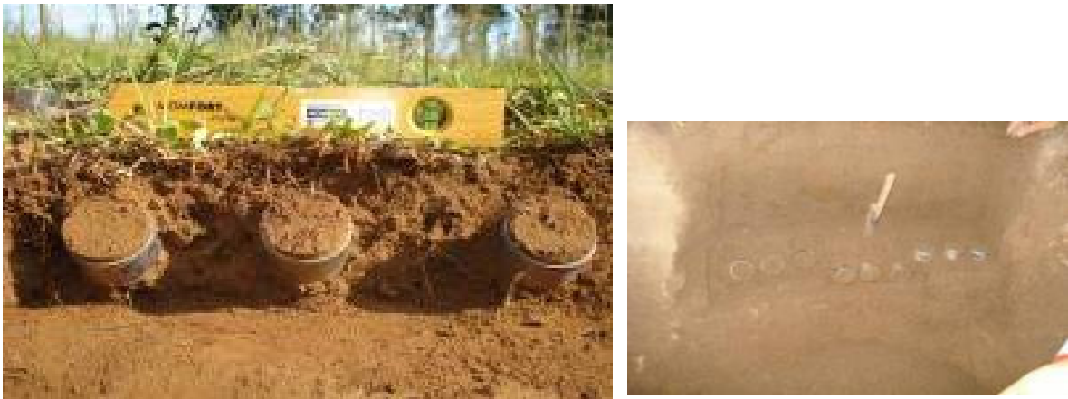
FIGURA 8 – Coleta de amostras para determinação de condutividade hidráulica nas três orientações de amostragem
