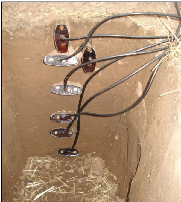
Figura 8 - Esquema da instalação das sondas no perfil do solo e da sonda utilizada.
