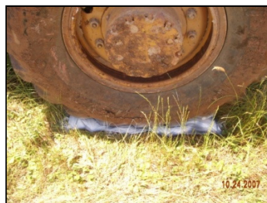
Figura 4 - Medida da área de contato entre o solo e o pneu.
