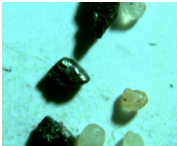
Figura 29 – Cristal cúbico de magnetita. Horz. A. Fração areia fina. Lupa 35x
