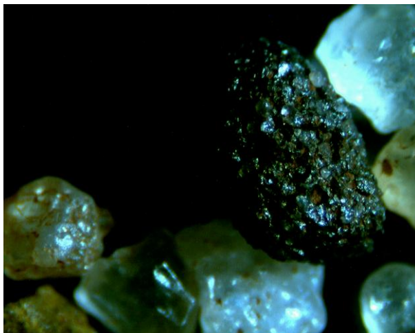
Figura 39- Agregado de quartzo cimentado por óxido de ferro. Horz. BC. Fração areia grossa. Lupa 35x.
