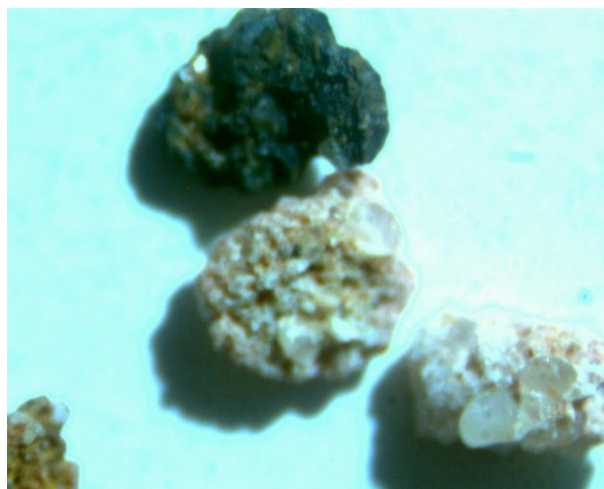
Figura 26 – Agregados de quartzo cimentados por sílica e óxido de ferro. Horz. C 3 . Fração areia grossa. Lupa 35x.
