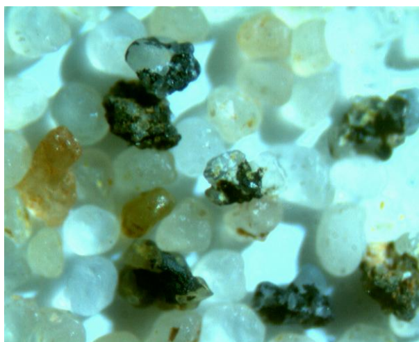
Figura 24 – Agregados de quartzo cimentados por óxido de ferro. Camada Cr. Fração areia grossa. Lupa 35x.
