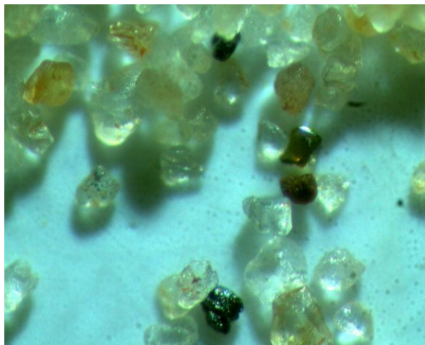
Figura 57 - grãos de rutilo (os dois inferiores e o superior) e de zircão (parte média superior). Horz. Bi. Fração areia fina. Lupa 35x.
