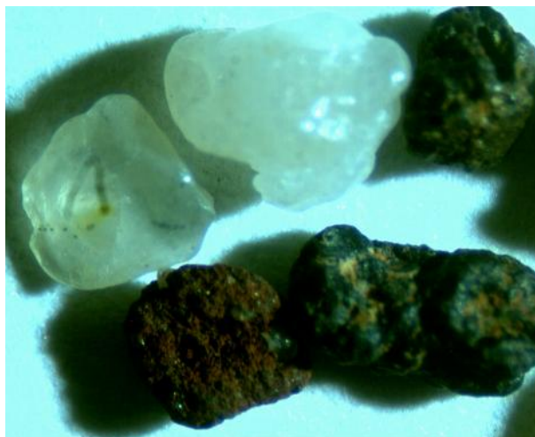
Figura 13 – Agregados de quartzo cimentados por óxido de ferro.Horz. BC. Fração areia grossa. Lupa – 40x
