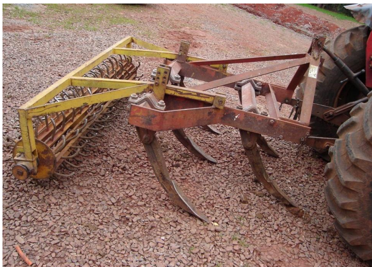
Figura 5 - Escarificador com rolo destorroador utilizado para descompactação mecânica do solo na área manejada em sistema plantio direto.
