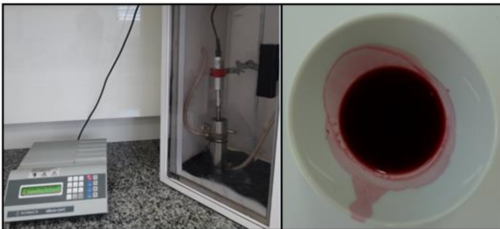
Figura 4 - Extração de compostos bioativos da casca de cebola roxa em sonda ultrassônica
