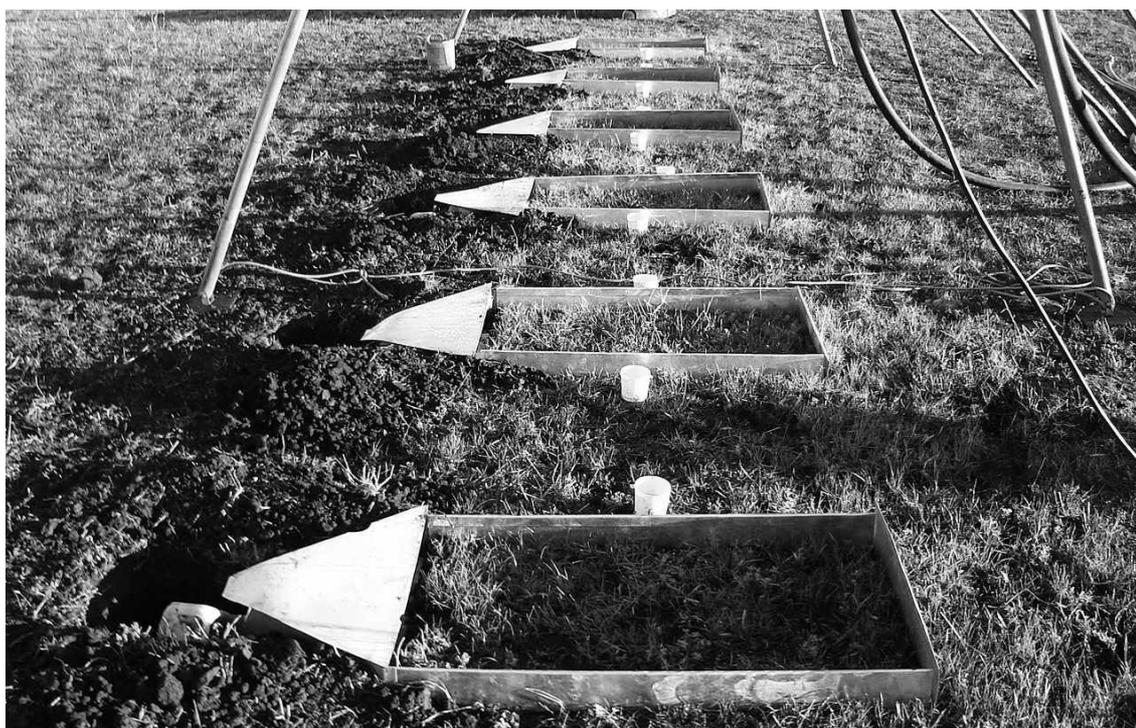
**Figura 4-** Detalhe das parcelas, calhas coletoras e pluviômetros utilizados nas avaliações das chuvas simuladas. Santa Maria, RS, 2007.
