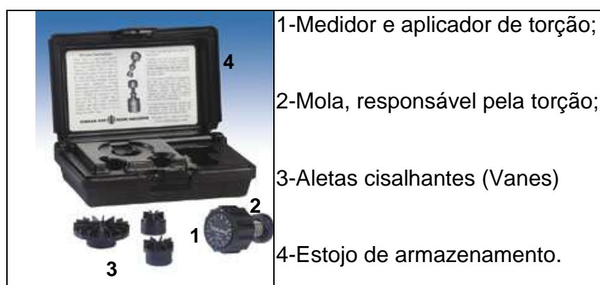
Figura 20 -Torvane para medição da resistência do solo ao cisalhamento.
