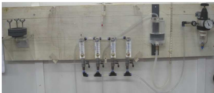
Figura 6 -Permeômetro de carga constante de ar.
