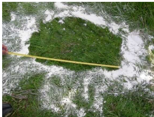
Figura 3 -Delimitação da área de contato pneu-solo.
