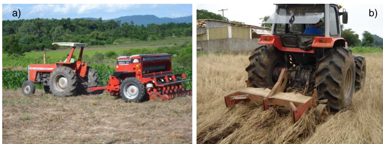
Figura 4 -Máquinas usadas no experimento. a) Trator (72cv) tracionando a semeadora; b) trator (92cv) tracionando o subsolador.
