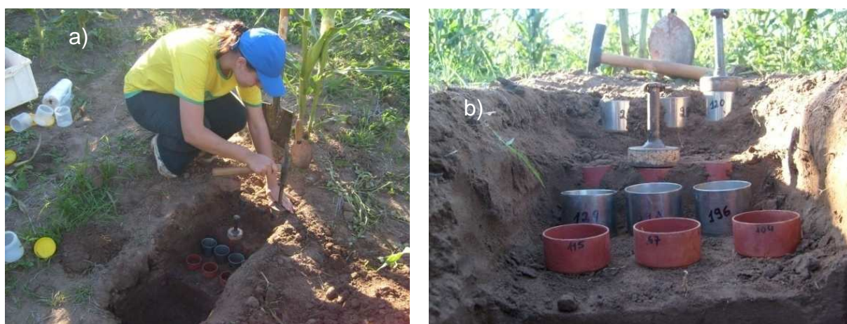
Figura 5 -a) Coleta de amostras de solo, b) Cilindros, extratores e martelo na trincheira de coleta.
