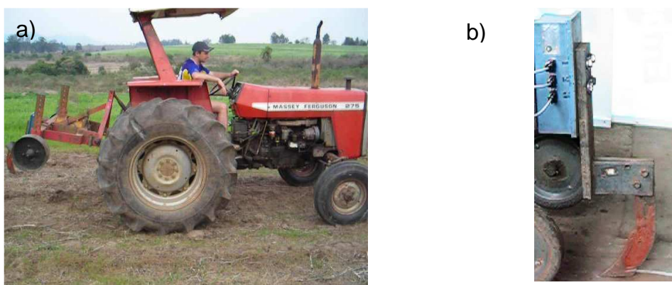
Figura 9 -a) Obtenção dos esforços solicitados a haste sulcadora no campo. b) Anel octogonal acoplado a haste sulcadora.
