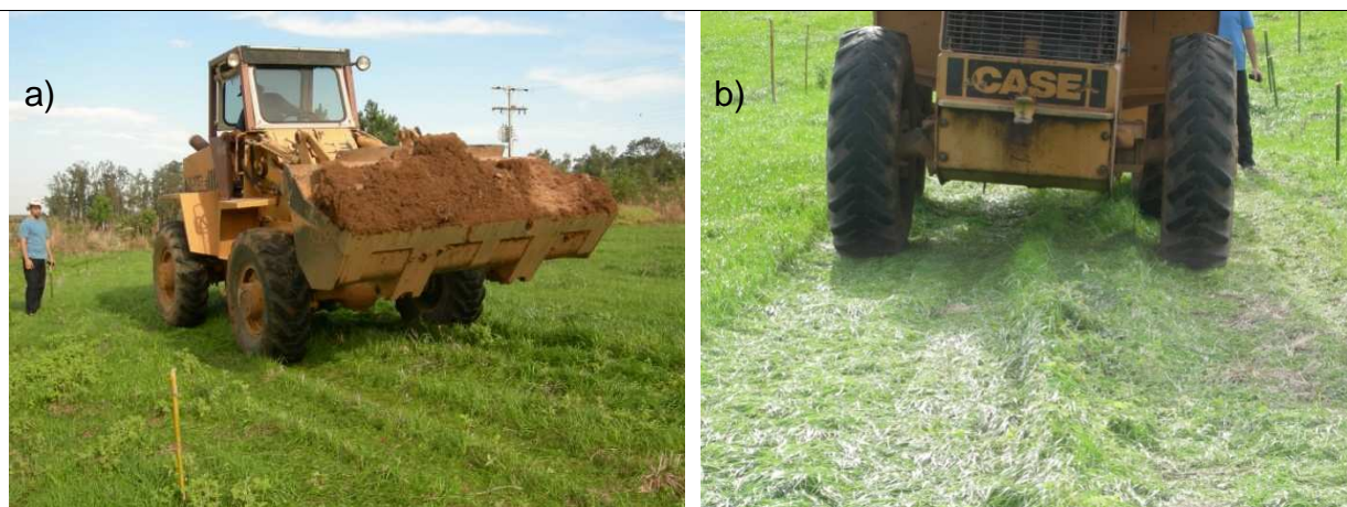
Figura 2 -a) Compactação do Argissolo Vermelho Amarelo antes da escarificação. b) Deformação do solo após o tráfego.
