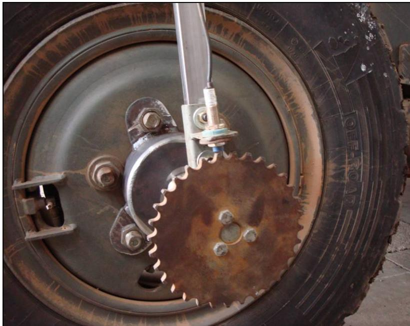
**Figura 11 - Medição de velocidade angular com sensor indutivo e roda dentada.**
