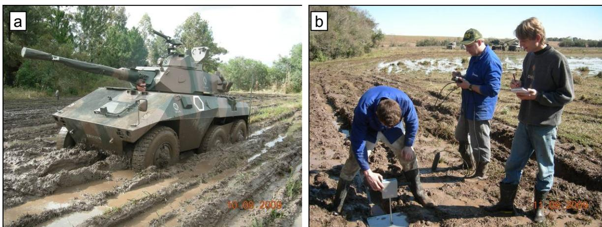
**Figura 22 - Trabalhos de campo realizados: a) tráfego do veículo Cascavel na área do NEMA/UFSM; b) momento da medição da penetrometria e umidade do solo na área do CIBLD/EB.**
