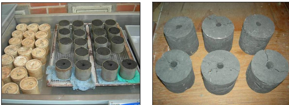
**Figura 10 - Cilindros de solo coletados para a obtenção do ICS em umidade controlada.**
