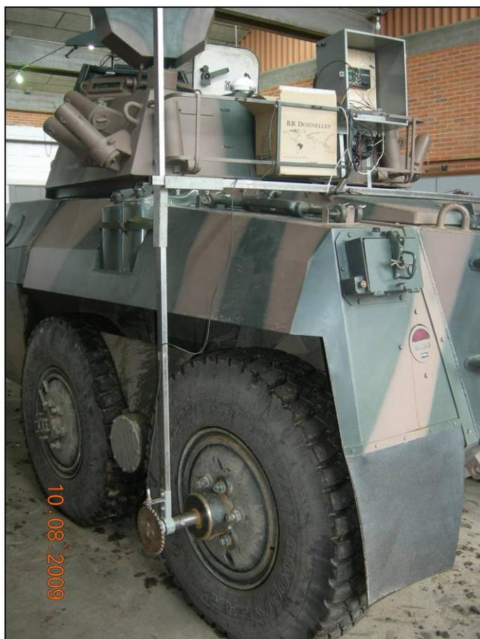
**Figura 13 - Veículo Cascavel instrumentado com sensor de roda, GPS e *datalogger*.**
