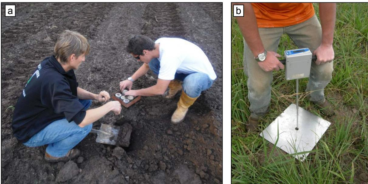
**Figura 37 - Determinação dos parâmetros de solo: a) coleta para obtenção da umidade; b) medição do índice de cone do solo.**
