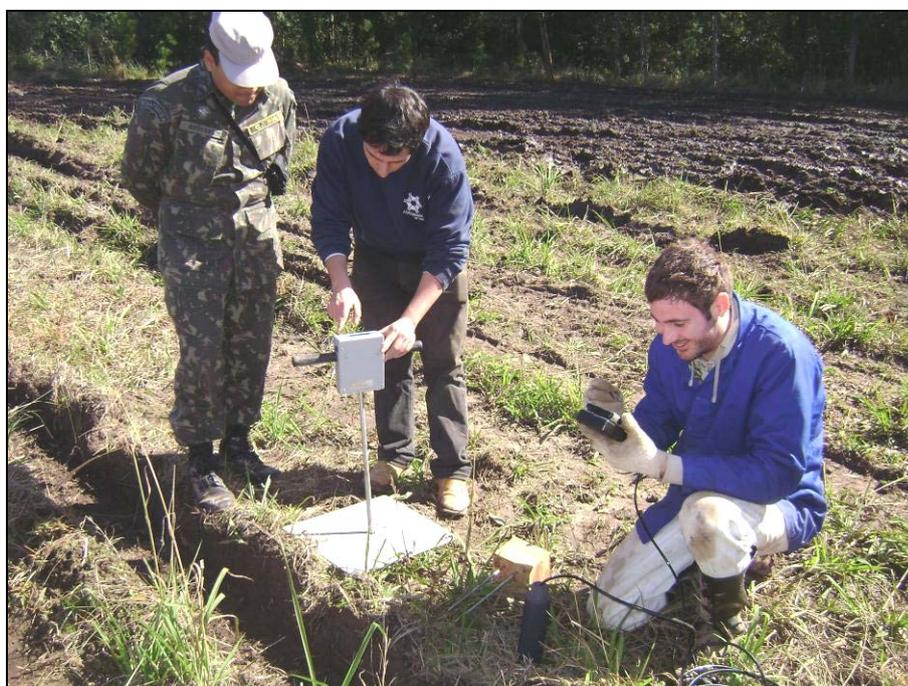
**Figura 9 - Momento da determinação da resistência à penetração do solo e da medição da umidade do solo na área experimental do NEMA/UFSM.**
