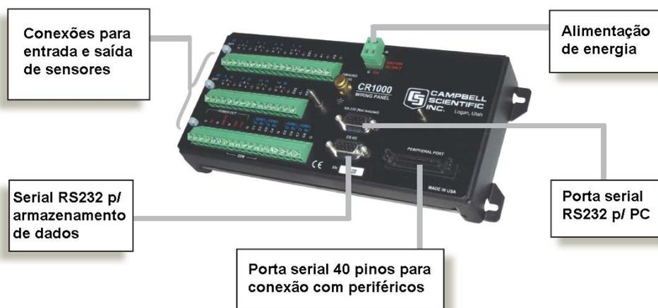
**Figura 12 - Datalogger de aquisição de dados CAMPBELL modelo CR1000 usado nos experimentos.**
