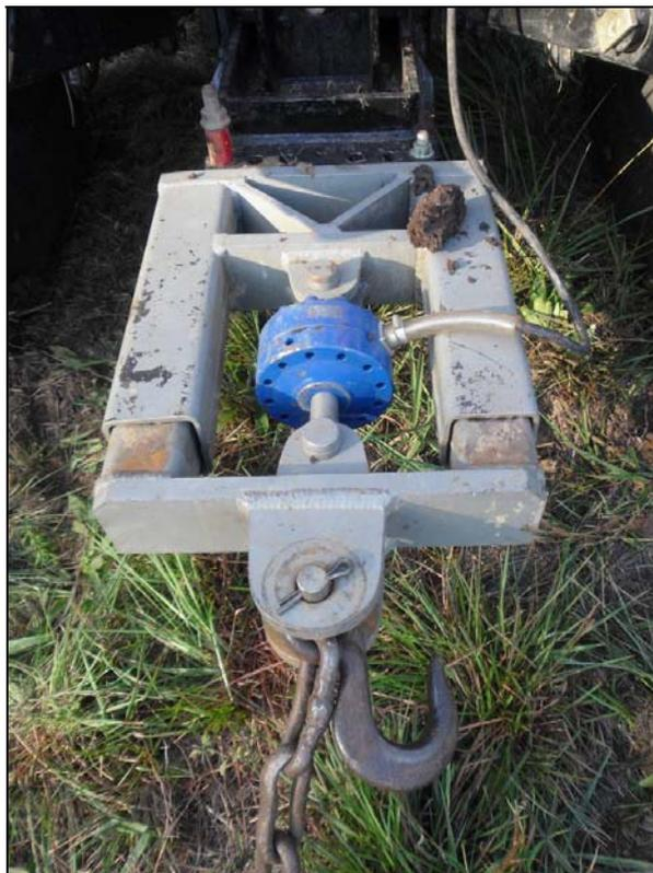
**Figura 34 - Sistema de engate da célula de carga para medição força de tração, desenvolvido por Russini (2009).**
