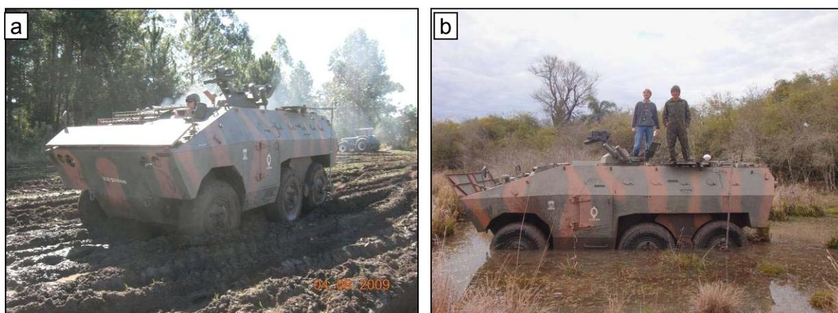
**Figura 17 - Testes de trafegabilidade a campo com veículo Urutu nos dois locais dos experimentos: a) NEMA/UFSM; b) CIBLD/EB.**
