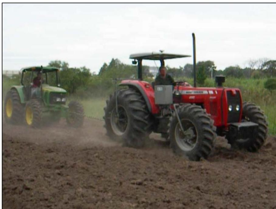
**Figura 28 - Arranjo do trator teste instrumentado acoplado ao trator freio.**
