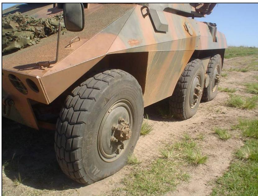
**Figura 6 - Viatura Cascavel com pneus ajustados para trafegar em baixa pressão.**
