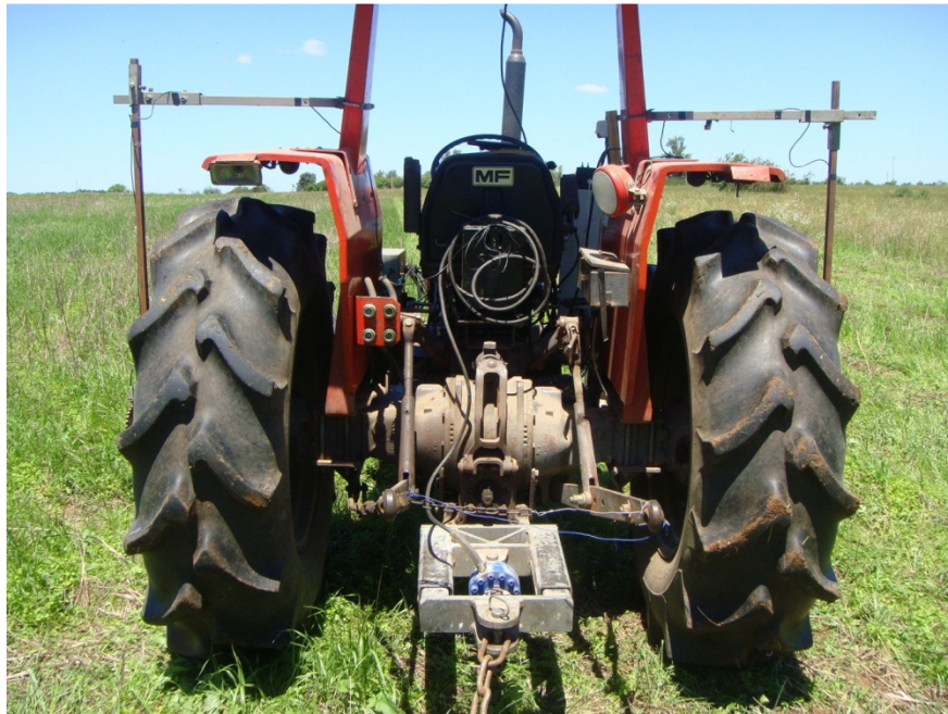
Figura 1.6 - Célula de carga instalada na barra de tração do trator.
