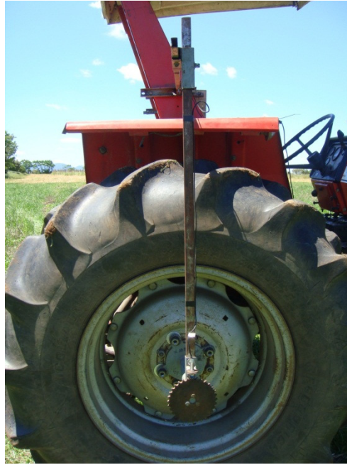
Figura 1.7 - Sensores instalados nas rodas motrizes.
