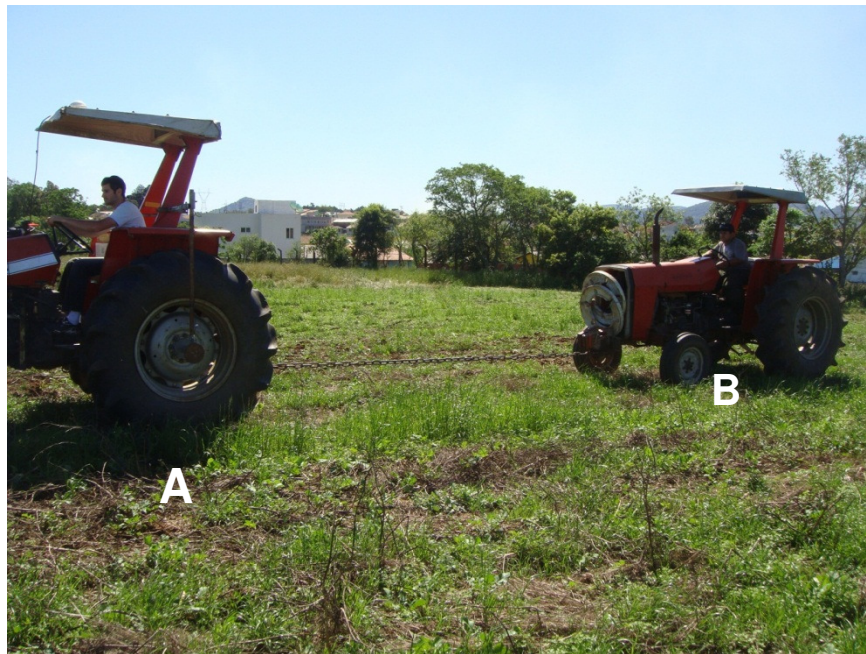
Figura 1.5 - Determinação da força de tração necessária para tracionar somente o trator reboque. Trator teste instrumentado eletronicamente (A) e trator reboque (B).
