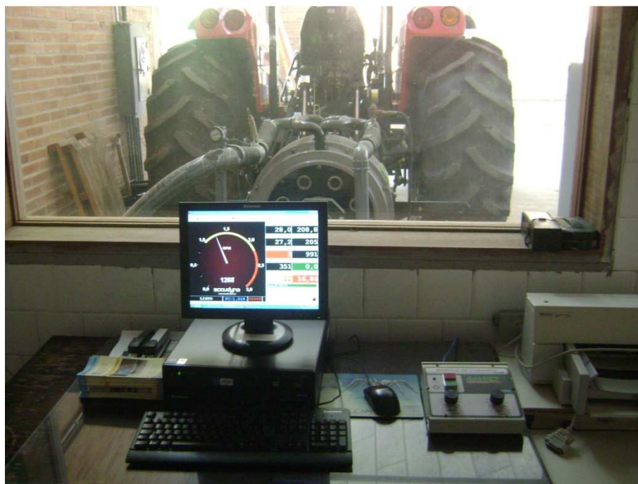
Figura 18 – Trator teste acoplado ao dinamômetro através da tomada direta de potência.
