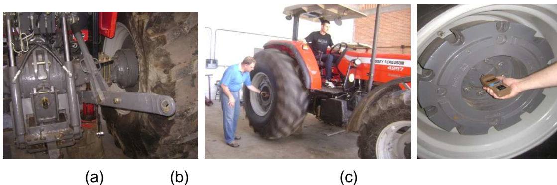
Figura 17 – Determinação da relação de transmissão: suspendendo-se a roda (a), marcha engrenada (b) e tacômetro no centro do eixo (c).
