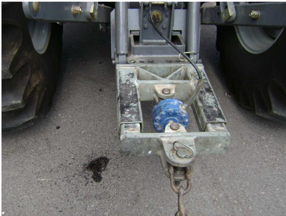
Figura 66 - Célula de carga acoplada a barra de tração para determinação da força de tração.
