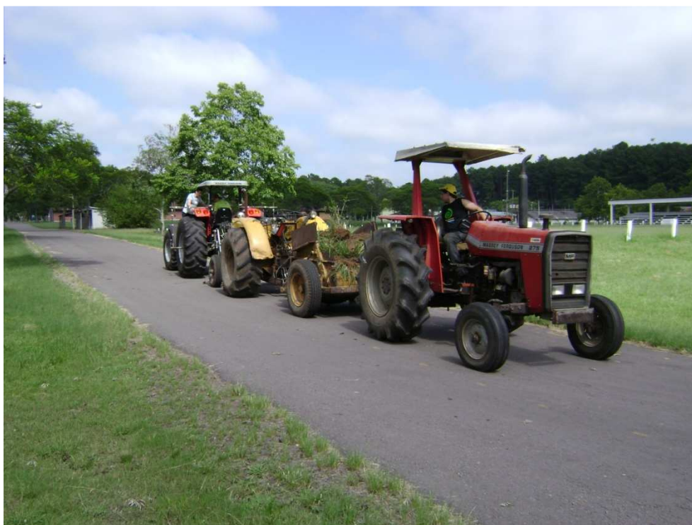
Figura 27 - Arranjo do trator teste e tratores freio para realização do ensaio de tração em pista.
