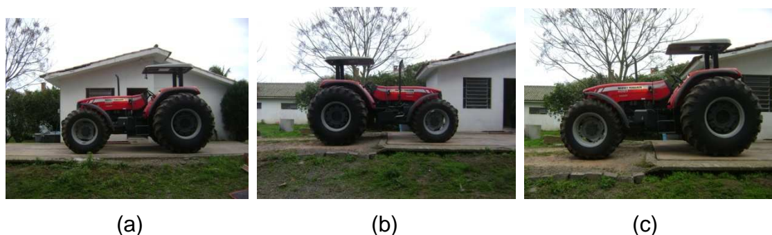
Figura 16 – Determinação do: peso total (a), peso do eixo dianteiro (b) e peso do eixo traseiro (c), para ajuste da distribuição de peso.
