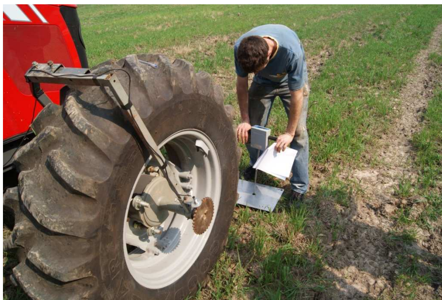
Figura 26 - Determinação da resistência à penetração na parcela.
