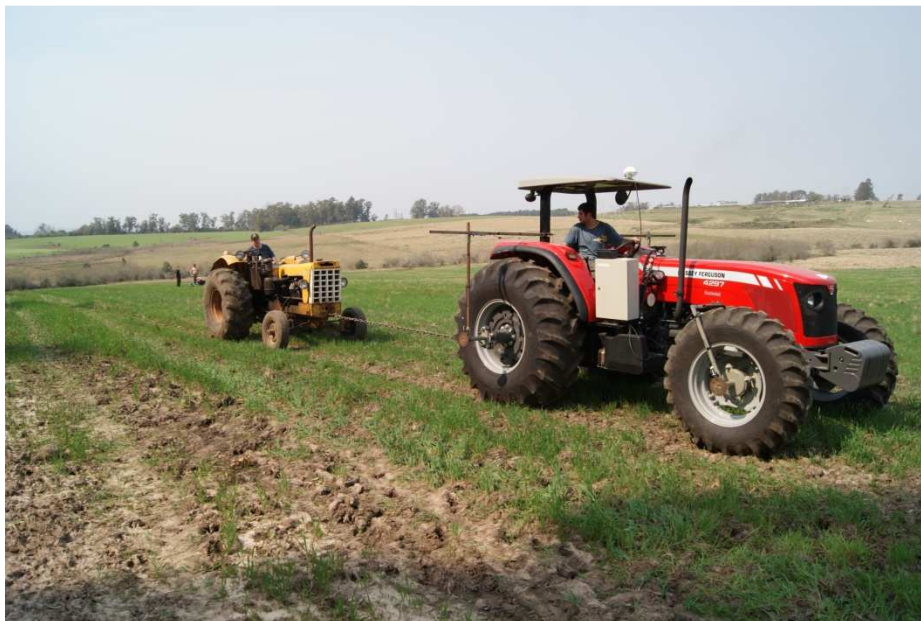
Figura 24 - Trator teste instrumentado acoplado ao trator freio.
