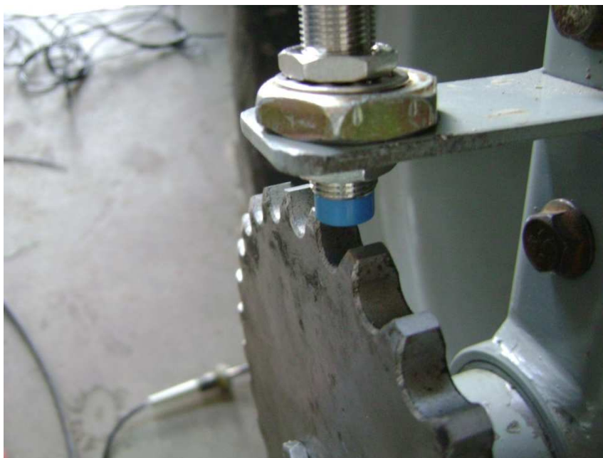
Figura 65 – Sensor indutivo e roda dentada fixado ao aro através de suportes.
