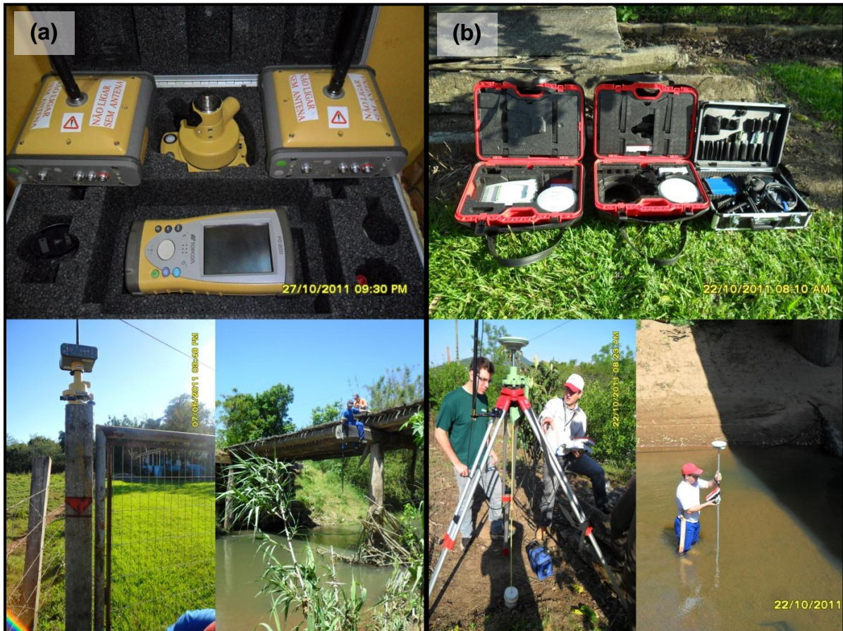
Figura 32 – Equipamentos GNSS utilizados na coleta de pontos do terreno e de pontos de marcas de enchentes.
