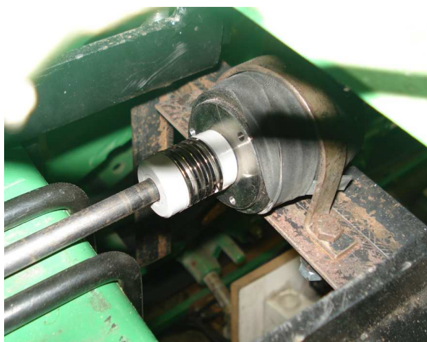
Figura 15 – Encoder óptico utilizado nas avaliações indiretas
