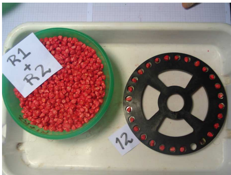
Figura A.1 – Primeiro passo do teste prático do ajuste entre sementes e discos
