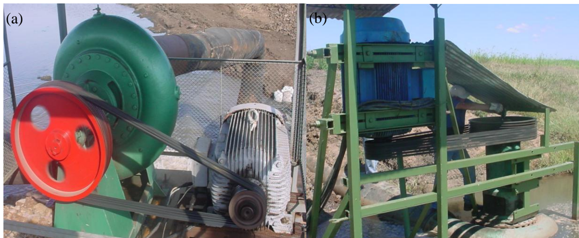
Figura 2. Acoplamento por polia e correias (a) eixo horizontal e (b) eixo vertical, encontradas em Uruguiana.
