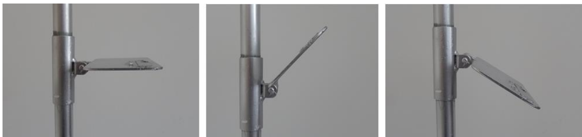
Figura 16 – Articulação do suporte para fixação da máquina fotográfica no Simulador da visualização do operador
