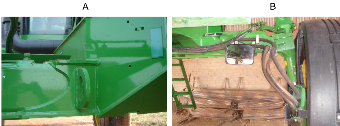
Figura 29 - Chassi rígido (A) com união do eixo ao chassi por meio de soldas(B). Fonte: Autor
