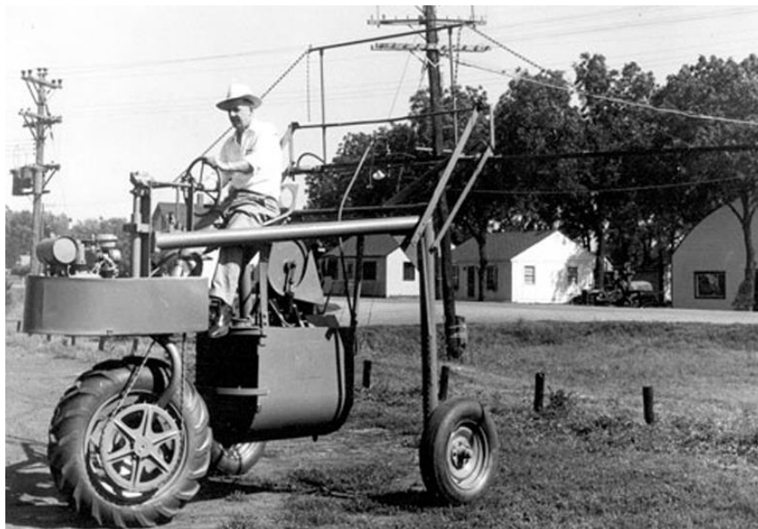
Figura 6: - Pulverizador autopropelido criado por Ray Hagie, em 1948.
