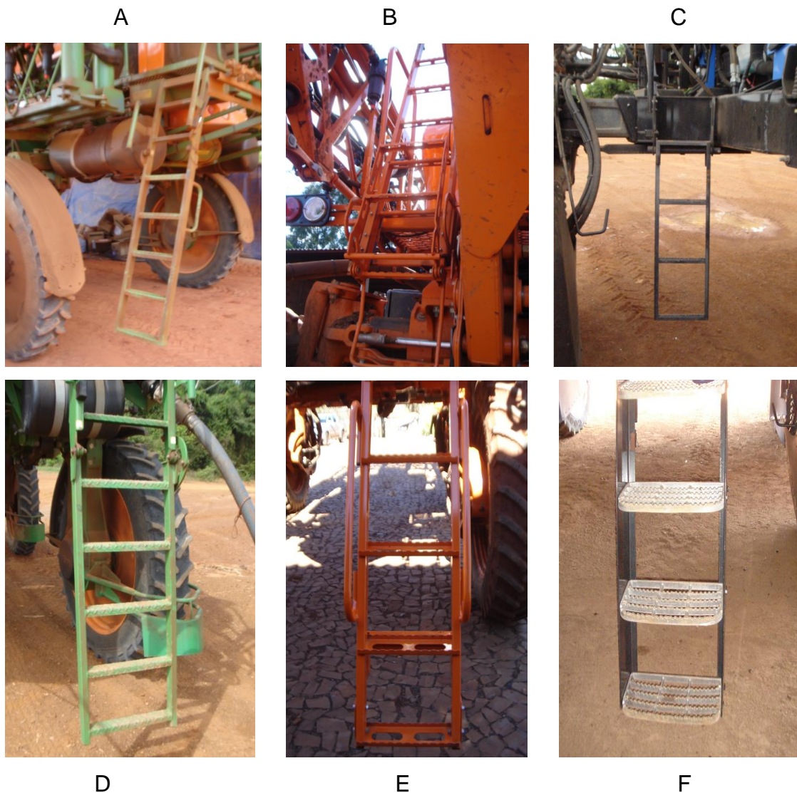
Figura 27 - Escadas de acesso ao motor com acionamento manual (A, B e C) e escadas de acesso as cabines com acionamento eletro-hidráulico (D, E e F) de três máquinas comercializadas no mercado brasileiro.
