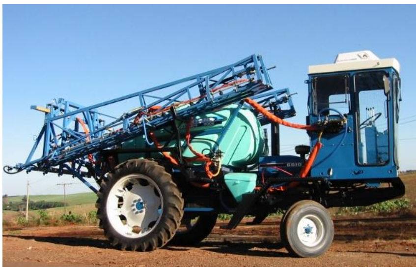
Figura 8 - Pulverizador autopropelido montado sobre um trator a partir de componentes de um pulverizador de arrasto.
