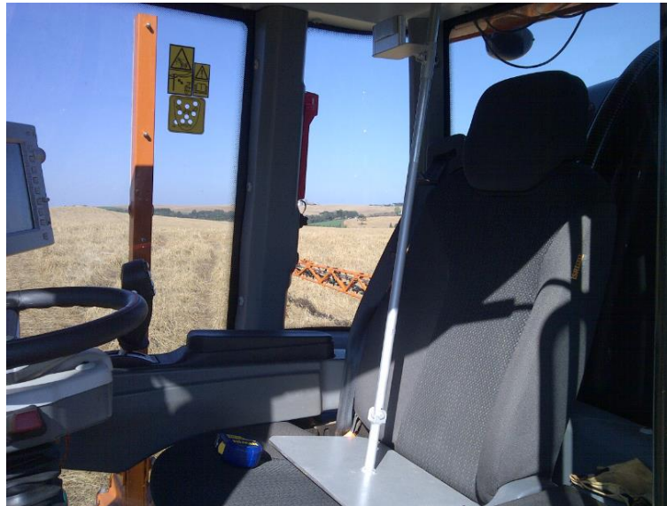
Figura 18 - Posicionamento do suporte para máquina fotográfica no assento de um pulverizador autopropelido Fonte: Autor
