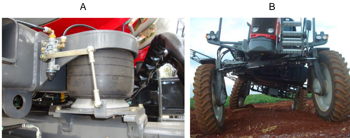
Figura 41 - Sistema de mola pneumática utilizada para amortecimento (A) e eixo articulado (B)
