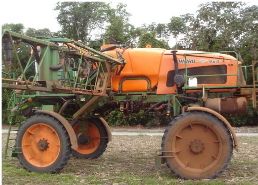
Figura 23 - Pulverizador com resíduos aderidos na parte traseira da máquina, utilizado para pulverização visando eliminar plantas espontâneas em pré-semeadura da soja na safra 2013/14, no Estado do Mato Grosso, Brasil.
