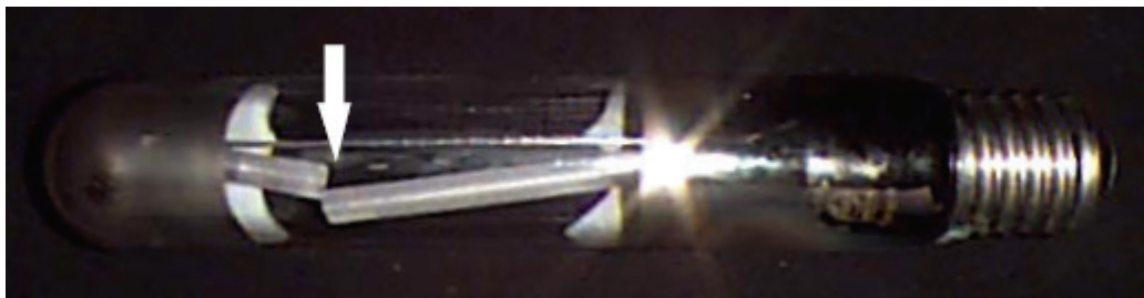
Figura 2.1 – Tubo de descarga rompido devido ao fenômeno da ressonância acústica (lâmpada HPS 400W) (Epron, 1999).
